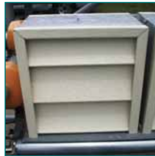
沖縄県／辺野喜のコンクリート試験体 サイディング施工あり（左）／施工なし（右）
